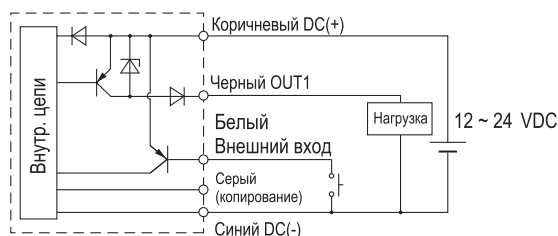
Выход PNP + внешний вход PF3W30H
