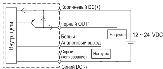
Выход PNP + внешний вход PF3W30H
