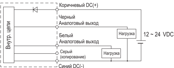
Два аналоговых выхода PF3W30J/PF3W30K
