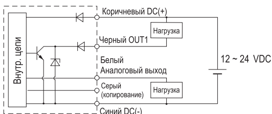
Выход NPN + внешний вход PF3W30G
